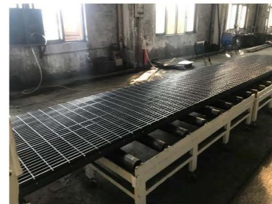
4. 设备内部的钢格板，直接由机构推送至设备外部，完成制作。
