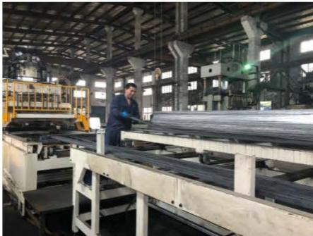
2. 黄色扭钢修边机构，焊接完成的钢格板在设备内部直接完成扭钢修边。
