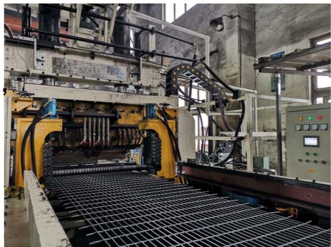
3. 焊接修边完成的钢格板直接堆垛至设备内部，减少人工干预，降低劳动力投入。
